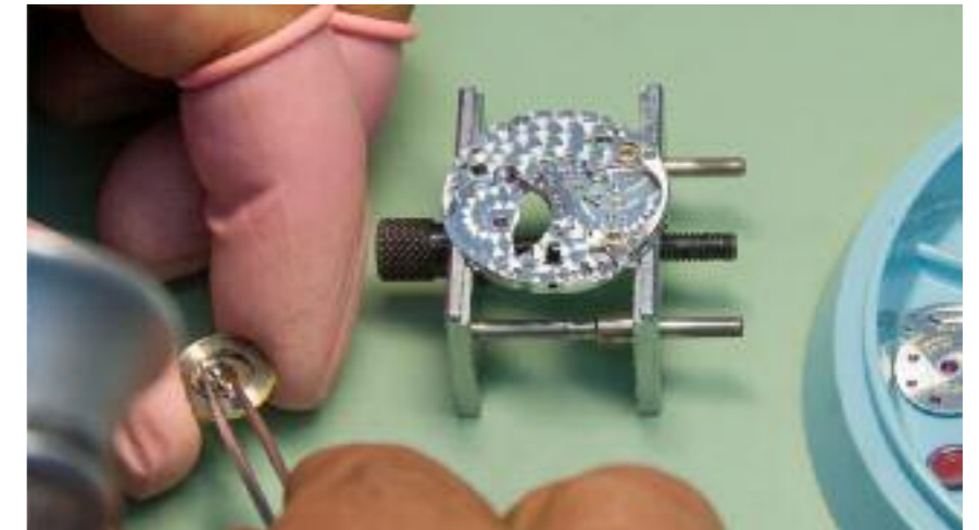
La molla di carica in una revisione generale viene normalmente sostituita. Nell'assemblaggio del movimento è importante la lubrificazione delle varie parti. IN BASSO: Il controllo di marcia del movimento. Si calcola l'errore in secondi/giorno, controllando l'ampiezza di oscillazione del bilanciere. Per un corretto funzionamento, con una frequenza di 28.800 alternanze/ora, l'ampiezza di oscillazione deve arrivare a un massimo di 290/300°. Il controllo dell'oscillazione viene eseguito di nuovo dopo 24 ore.
