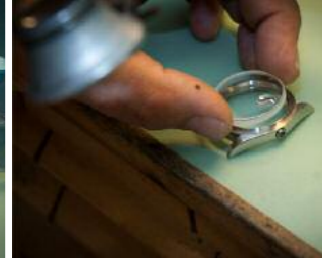
Le varie parti dell'habillage sono pronte per essere riassemblate. Le guarnizioni sono tutte sostituite. A DESTRA: La posa del vetro sulla cassa. IN BASSO: La posa delle lancette sul quadrante.
