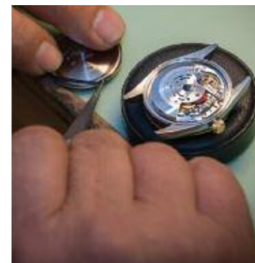
L'inserimento del movimento nella cassa e il serraggio del fondello.
