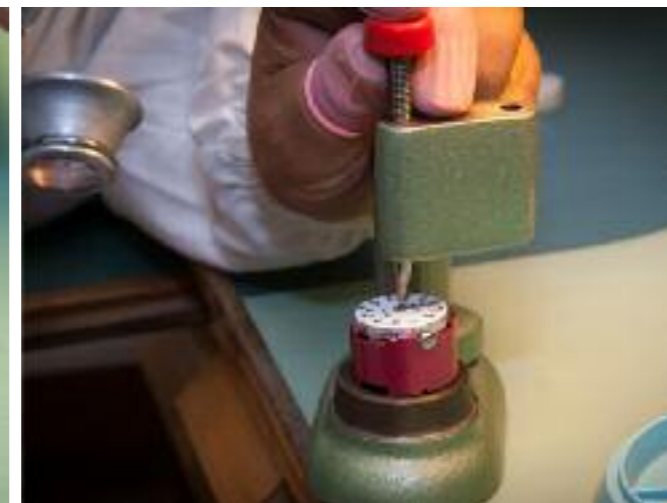
Le varie parti dell'habillage sono pronte per essere riassemblate. Le guarnizioni sono tutte sostituite. A DESTRA: La posa del vetro sulla cassa. IN BASSO: La posa delle lancette sul quadrante.
