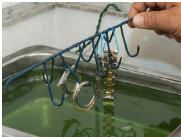
Le componenti dell'habillage al lavaggio in una vasca a ultrasuoni in acqua calda. A DESTRA: Il bracciale viene satinato sui fianchi. Le maglie centrali, che devono rimanere lucide, sono protette da uno speciale nastro adesivo.
