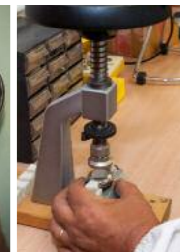
L'inserimento del movimento nella cassa e il serraggio del fondello.
